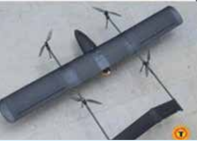
फिक्सड विंग- रोटर हायब्रीड ड्रोन (Fixed Wing-Rotor Hybrid VTOL)
